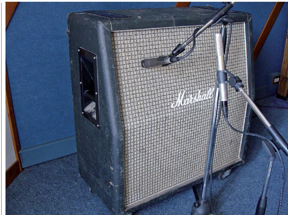
**Fig. 1** Un Marshall microfonato con SM57 e R122
