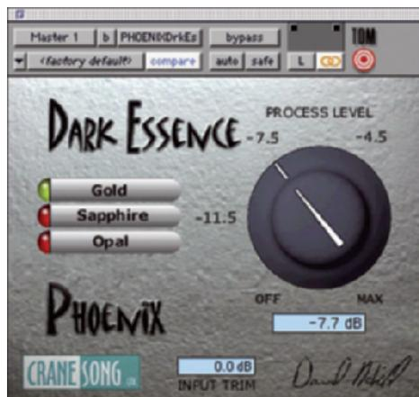
Fig. 2 Il Phoenix di Crane Song, uno dei plug-in più usati per emulare il nastro magnetico
